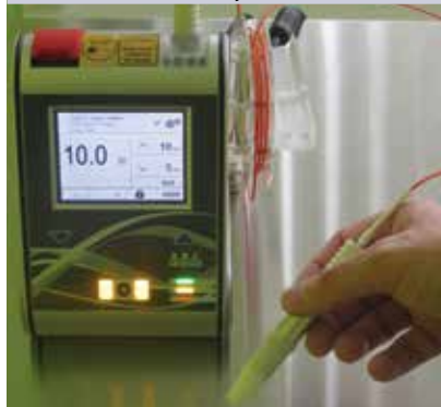
Figuur 2: De vlek is ongeveer 4,0mm groot en de werkafstand ongeveer 1cm.
