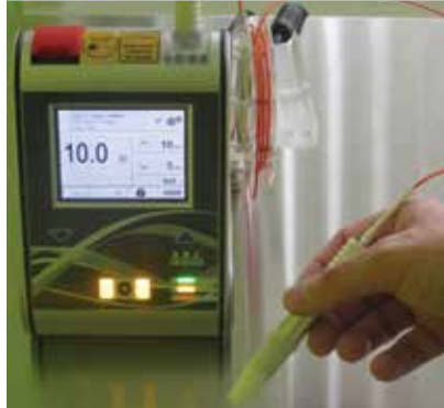
Figure 2: La taille du spot est d'environ 4,0mm et la distance de travail d'environ 1cm.
